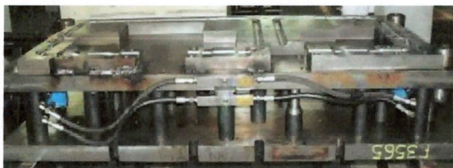
Figura 5: Ferramenta para prensa de tubo metálico (Armaduras para banco)
